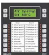
**M3000 ALARM MONITOR:** Le M3000 est une version avancée de la gamme de panneau d'alarme Selco, il offre le choix à l'utilisateur d'utiliser 24 entrées configurables pour accueillir un contact sec ou une entrée analogique mA, + /-10VDC, PT100,...
