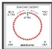
**M8100 :** Fournit une indication en temps réel de la différence de phase entre la tension du générateur et la tension du jeu de barres. Les deux LED vertes en haut signalent que le disjoncteur du générateur peut être fermé. Un modèle est disponible avec un relais d'autorisation. Il dispose de l'agrément marine. Format : 96 x 96 x 80 mm.
