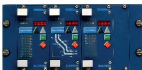
**Souplesse d'exploitation :** relais individuels ou combinés, deux séries de paramètres, configuration libre des relais de sortie (matrice), protection contre les pannes de disjoncteurs, affichage des valeurs primaires, protocole Modbus RTU, boîtier compact compatible rack 19 pouces.
