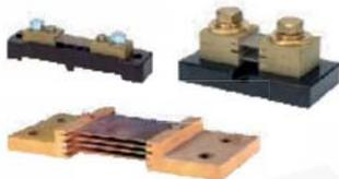
La gamme Crompton est très étendue, elle permet la mesure de courant de 10 à 10 000 A avec des sorties standards en 50 mV, 60 mV, 75 mV, 100 mV et 150 mV. Ils respectent les normes DIN 43 703 et IEC 51 EN60051.
