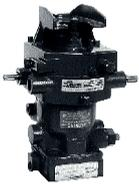
**PSG :** ce régulateur hydraulique permet de contrôler de petits moteurs gaz, essence ou diesel et de petites turbines vapeur ou gaz en mode isochrone ou avec statisme. Ajustage de la vitesse par levier, moteur électrique ou pneumatique.
