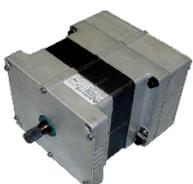
**Système intégré L-Series :** Ce système, destiné aux petits moteurs, intègre à la fois un actionneur bidirectionnel et régulateur à microprocesseur. Rotation de 60°, alimentation 10-32V<sub>DC</sub>, température de fonctionnement -40 à +105°C, configurable par PC. Il existe en version pour pompe Stanadyne, pour pompe Delphi, associé à un carburateur ou un mélangeur...
